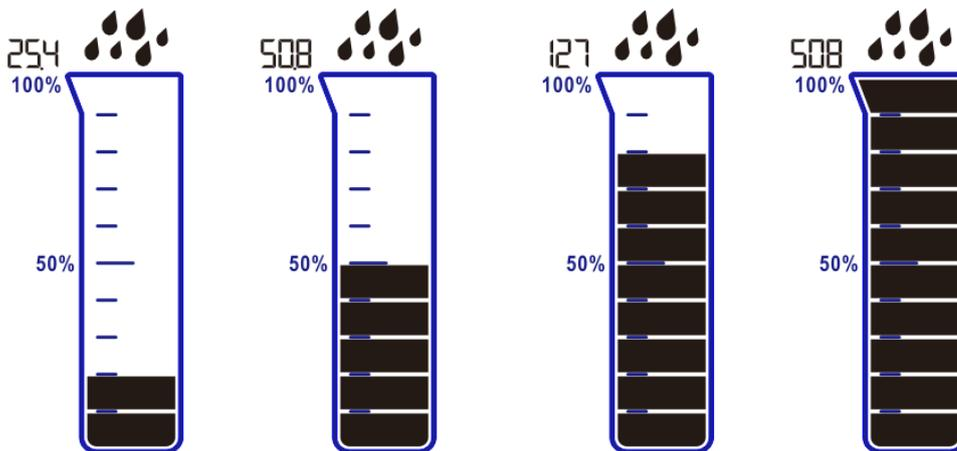
Cilindro grafikas rodo kritulių kiekį realiuoju laiku, neatsižvelgiant į aktyvųjį rodymo režimą. Cilindras suskirstytas į 10 segmentų. Kiekvienas segmentas reiškia 10 proc. esamos cilindro talpos (vertė A11, mm arba in, atsižvelgiant į parinktį). Viršijus 100 proc., bendroji cilindro talpa padidinama, o vertės procentais (segmentai) atnaujinami automatiškai.
