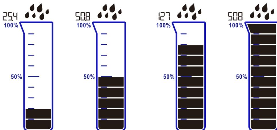
Le graphique indique la quantité de précipitations en temps réel, quel que soit le mode d'affichage actif. L'éprouvette est divisée en 10 segments. Chacun des segments représente 10% de la contenance actuelle de l'éprouvette (A11, mm ou in, en fonction des réglages précédemment sélectionnés). Lorsque 100% est dépassé, la contenance totale augmente et les pourcentages (segments) sont mis à jour automatiquement.
