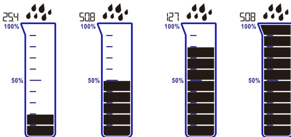
Silindri graafik näitab sademete hulka reaalaaja režiimis, aktiivsest kuvarežiimist sõltumata. Silinder on jaotatud 10 segmendiks. Iga segment sümboliseerib 10% silindri aktuaalsest mahust (väärtus F11, mm või in, sõltuvalt eelnevalt kehtestatud seadetest). 100% ületamise hetkel silindri üldmahtu suurendatakse, aga protsendiväärtused (segmentid) aktualiseeruvad automaatselt.
