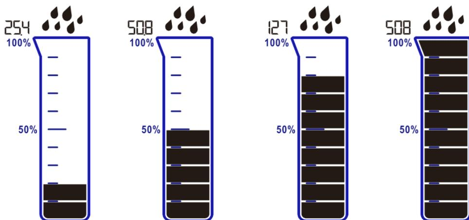
Diagrama cilindrului indică cantitatea de precipitații în timp real, indiferent de modul de afișare activ. Cilindrul este divizat în 10 segmente. Fiecare dintre segmente simbolizează 10% din capacitatea curentă a cilindrului (A11, mm sau in, în funcție de setările selectate anterior). Când se depășește 100%, capacitatea totală a cilindrului va fi mărită, iar procentele (segmentele) vor fi actualizate automat.
