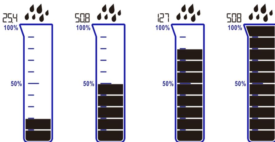
График цилиндра показывает количество осадков в режиме реального времени, независимо от активного режима отображения. Цилиндр разделен на 10 сегментов. Каждый сегмент символизирует 10 % актуального объема цилиндра (значение Ф11, мм или in, в зависимости от ранее установленных настроек). В момент превышения 100 %, общий объем цилиндра будет увеличен, а процентные значения (сегменты) автоматически актуализируются.
