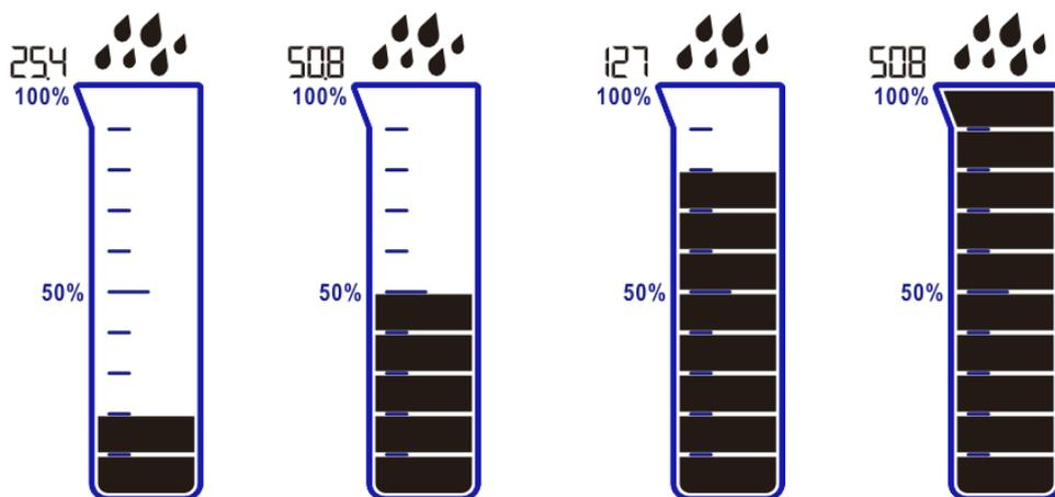
Cilindra grafiks rāda nokrišņu daudzumu reālā laika režīmā, neatkarīgi no aktīvā atainošanas režīma. Cilindrs ir iedalīts 10 segmentos. Katrs segments simbolizē 10 % no aktuālā cilindra apjoma (vērtība  $\Phi 11$ , mm vai in, atkarībā no iepriekšējiem iestatījumiem). 100% pārsniegšanas brīdī, cilindra kopējais apjoms tiks palielināts, bet procentu vērtības (segmenti) automātiski aktualizēsies.
