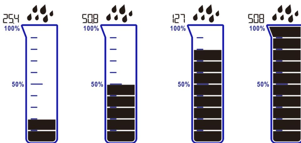
Wykres cylindra pokazuje ilość opadów w czasie rzeczywistym, niezależnie od aktywnego trybu wyświetlania. Cylinder podzielony jest na 10 segmentów. Każdy z segmentów symbolizuje 10% aktualnej przyjętej pojemności cylindra (wartość A11, mm lub in, w zależności od wcześniej wybranych ustawień). W momencie przekroczenia 100%, całkowita pojemność cylindra zostanie zwiększona, a wartości procentowe (segmenty) zaktualizują się automatycznie.
