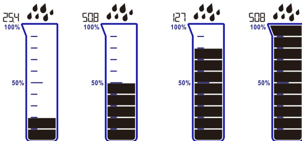
Na schéme merania pomocou meracieho prístroja je zobrazené množstvo zrážok v reálnom čase, bez ohľadu na aktuálny režim zobrazovania. Merací prístroj je rozdelený na 10 segmentov. Každý segment symbolizuje 10% aktuálnej kapacity meracieho prístroja (hodnota A11, mm alebo in, podľa skôr zvolených nastavení). V prípade prekročenia 100% sa celková kapacita meracieho prístroja zväčší a percentuálne hodnoty (segmenty) sa budú aktualizovať automaticky.
