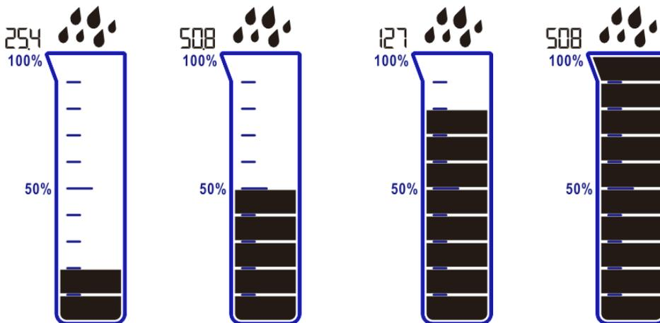
Das Diagramm des Zylinders zeigt die Niederschlagsmenge in Echtzeit, unabhängig vom aktiven Anzeigemodus. Der Zylinder ist in 10 Segmente unterteilt. Jedes der Segmente stellt 10% des aktuellen Fassungsvermögens des Zylinders dar (Wert A11, mm oder in, je nach den vorher ausgewählten Einstellungen). Im Augenblick der Überschreitung von 100% wird das Gesamtfassungsvermögen des Zylinders vergrößert und die Prozentwerte (Segmente) werden automatisch aktualisiert.
