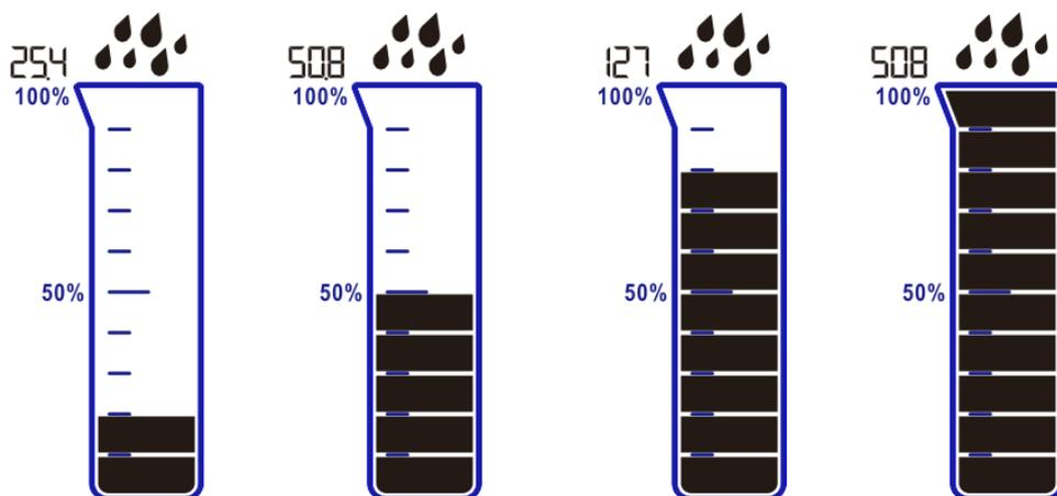
Výkres válce ukazuje množství srážek v reálném čase nezávisle na aktivním režimu zobrazení. Válec je rozdělen na 10 segmentů. Každý ze segmentů symbolizuje 10% aktuálního objemu válce (hodnota A11, mm nebo in, podle předvoleného nastavení). Ve chvíli překročení 100% se celkový objem válce zvětší a procentní podíly (segmenty) se automaticky přepočítají.
